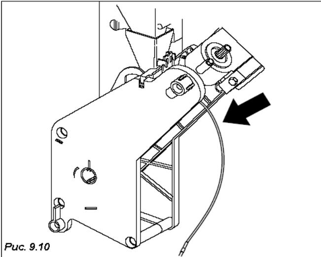
В процессе транспортировки поворотный указатель не должен быть смещен вперед более чем на 1,5 мм относительно метки транспортировочного положения (величина смещения должна быть в пределах от 0 до 1,5 мм).
